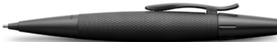
Drehbleistift: Stufenlose Drehmechanik, mit 1,4 mm bruchfester Mine im Härtegrad B, austauschbarer Radierer unter der Endkappe. Propelling pencil: continuous twist mechanism, break-resistant 1.4-mm lead of hardness B, replaceable eraser under the cap.
